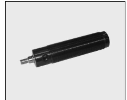
➤ O Booster Hidro-pneumático funciona através do diferencial de área que existe entre a câmara hidráulica da câmara pneumática, podendo assim trabalhar com fluido hidráulico em alta pressão, sem necessidade de conjuntos hidráulicos como por exemplo as UH.
